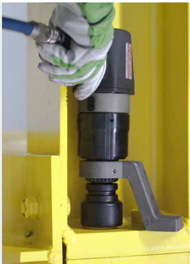
alkitronic® CLD/L Anwendung im Stahlbau
