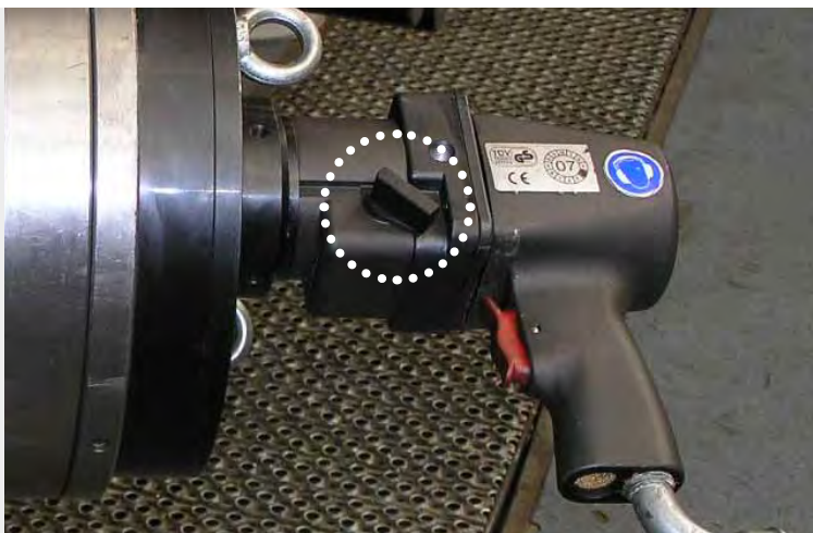
alkitronic® CLS2 2-Gang Drehmoment-schrauber. Mechanisch umschaltbar vom Schnellgang in den Kraftgang.
